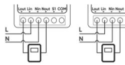
Схемы подключения модуля в разрыв проводки к осветительным приборам:
